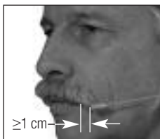
Fig. 9: Posición acústica óptima del micrófono
