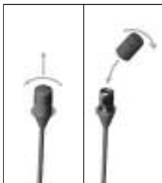
Abb. 10: Höhenanhebungskappe PB 77 montieren
