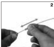
Fig. 8/1, 2, 4: Ajustar o braço do microfone
