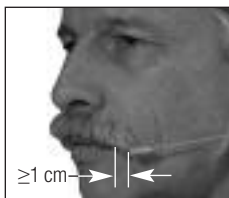
Fig. 9: Posizione del microfono con acustica ottima
