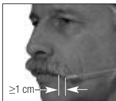
Abb. 9: Akustisch optimale Mikrofonposition.
