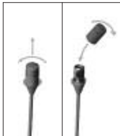
Fig. 10 : Montage du capuchon d'accentuation de l'aigu PB 77
