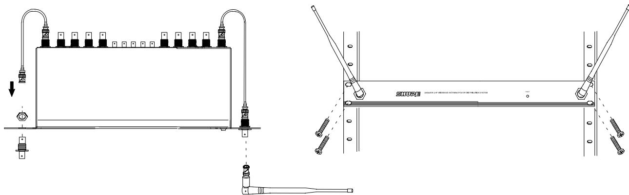
CABLE CONNECTIONS, ONE UA844    BRANCHMENTS DU CÂBLE, UN UA844    KABELVERBINDUNGEN, EIN UA844
